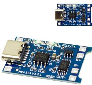
Módulo de Carga para batería de Litio Tipo C MOD-TP4056-1A
